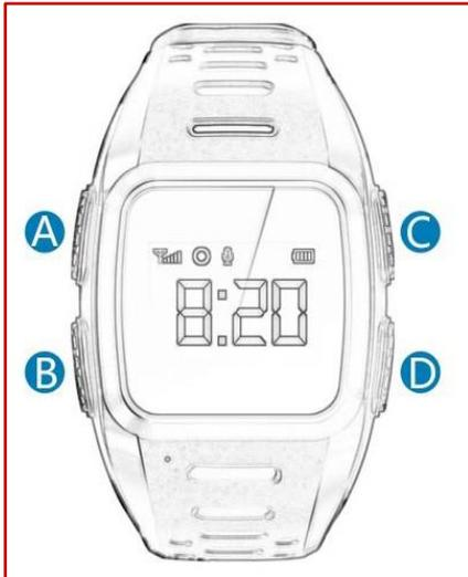
Die GPS Uhr Capri ist mit 4 bedienbaren Tasten ausgestattet. (A, B, C, D)
